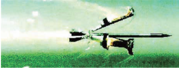
Şekil 9.9: Uranyumlu merminin uçuş sırasında yan parçalarından ayrılarak ok gibi hedefe yönelmesi
